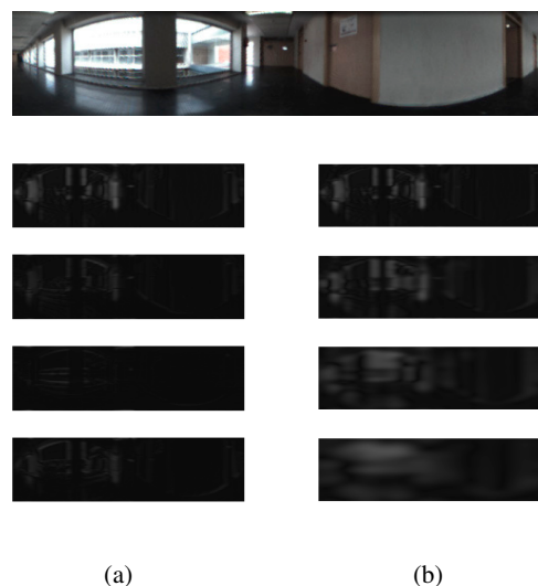
Figura 4: Ejemplo de filtrado de imagen con (a) distintas orientaciones ( 0^\circ , 45^\circ , 90^\circ , 135^\circ ) y (b) diferentes escalas.
